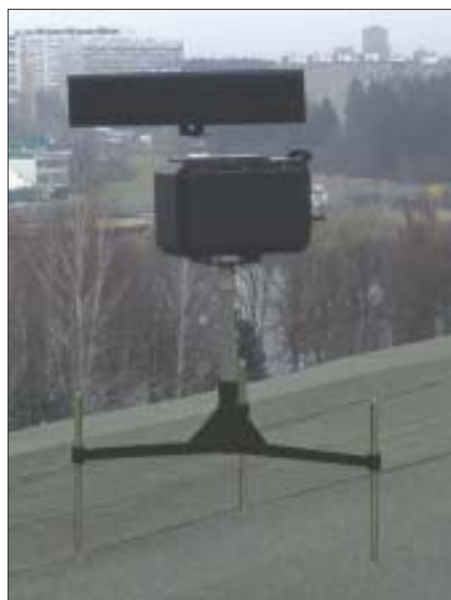
Рис. 1. Радиолокационная система (РЛС) охраны периметра и территории объектов
