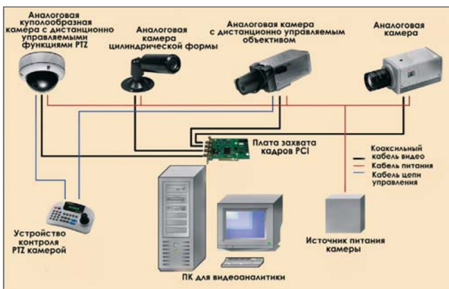
Рис. 1. Видеоаналитика на базе аналоговых камер с устройством захвата кадров и ПК
