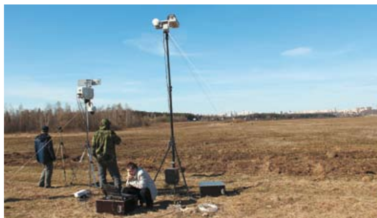
Рис. 4. Применение тепловизионного локатора кругового обзора в качестве быстроразворачиваемой системы охраны
