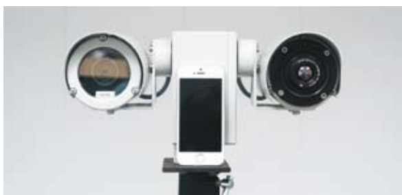
Рис. 2. Сравнительные размеры мобильного телефона и камер ИК и видимого диапазонов на поворотной платформе тепловизионного локатора кругового обзора
